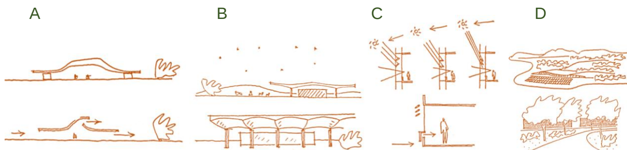
Figura 1 – Ilustrações de Armando de Holanda sobre as recomendações de sombra: (A) criar uma sombra; (B) recuar as paredes; (C) proteger as janelas; (D) conviver com a natureza.
